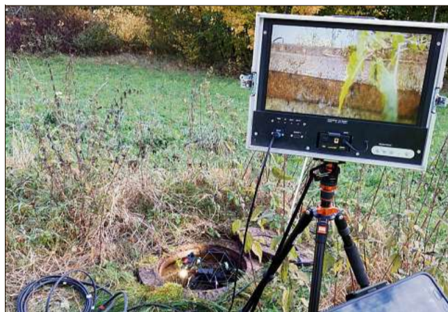
Auf einem Monitor kann jede Bewegung der Drohne im Kanal verfolgt werden.
